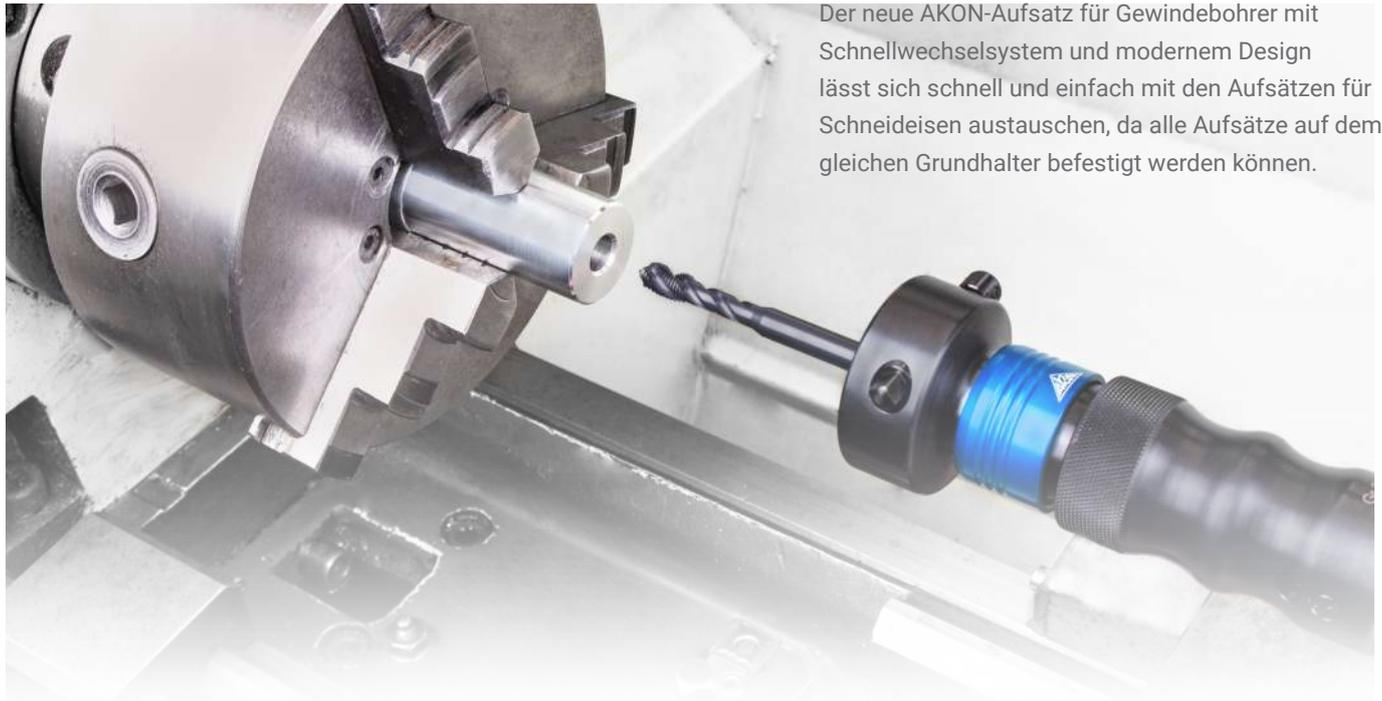
Der neue AKON-Aufsatz für Gewindebohrer mit Schnellwechselsystem und modernem Design lässt sich schnell und einfach mit den Aufsätzen für Schneideisen austauschen, da alle Aufsätze auf dem gleichen Grundhalter befestigt werden können.
